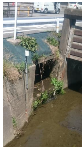
写真2 水位センサーとLPWAN実装状況
